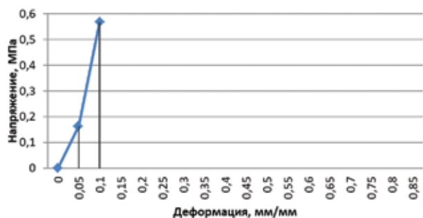
Рис. 4. График зависимостей напряжение-деформация при скорости перемещения траверсы 500 мм/мин
