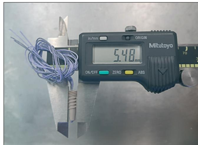
Рис.2. Измерение диаметра узлового якорного фиксатора
