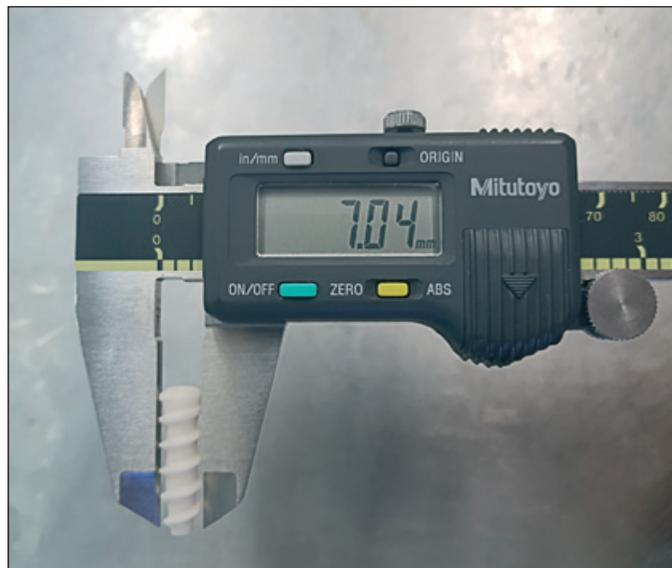
Рис. 1. Измерение диаметра интерферентного винта
