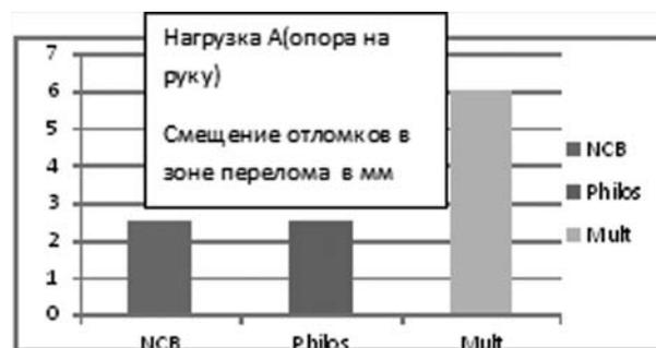
Рис. 6. Сравнительная диаграмма смещения отломков в мм при трехфрагментарном переломе при опоре на руку
