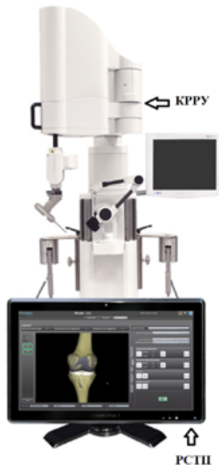
Рис. 1: Роботизированная хирургическая (ортопедическая) система состоит из рабочей станции трехмерного планирования (РСТП) и компьютеризованного роботизированного режущего устройства (КРРУ)
