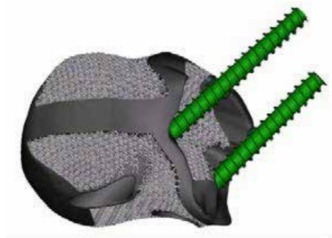
Рисунок 28. Спроектированная модель титанового импланта
