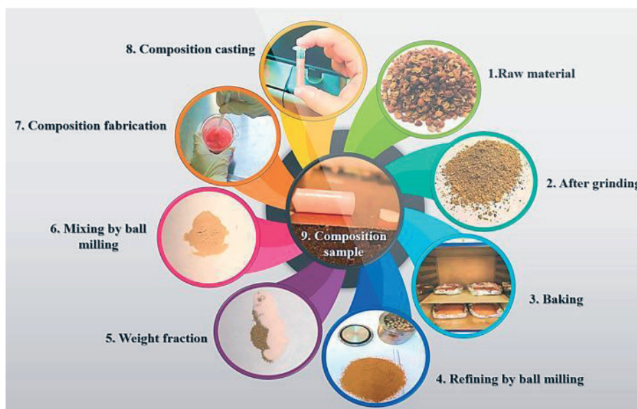
Рисунок 2. Схема подготовки образцов композита из ПММА и кофейной шелухи [42]
